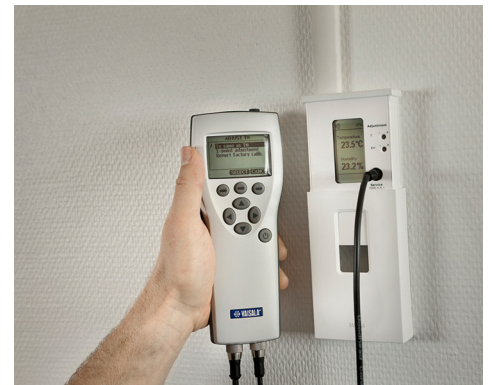
使用 HM70 手持式仪表进行现场校准
